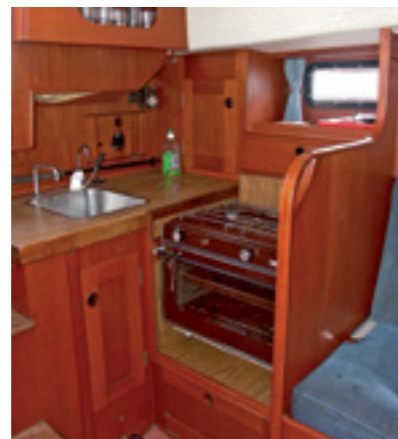
Die Schiebantrist gut gelagert und verschwindet bei Nichtgebrauch unter der Cockpitducht, für Pött und Pann ist ausreichend Stauraum vorhanden
