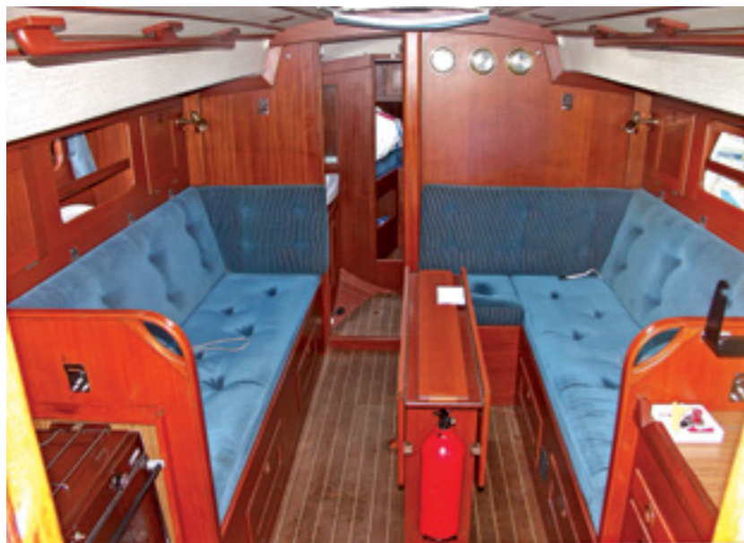
Typisch Hallberg-Rassy: Warme Holzöne kontrastieren mit den weißen Flächen der Deckenverkleidung. Das Schiff ist für den Gebrauch auf See sinnvoll aufgeteilt, Stauraum gibt es überdurchschnittlich viel. Durch lange Handläufe kann man sich auch bei ruppigem Wetter sicher bewegen
