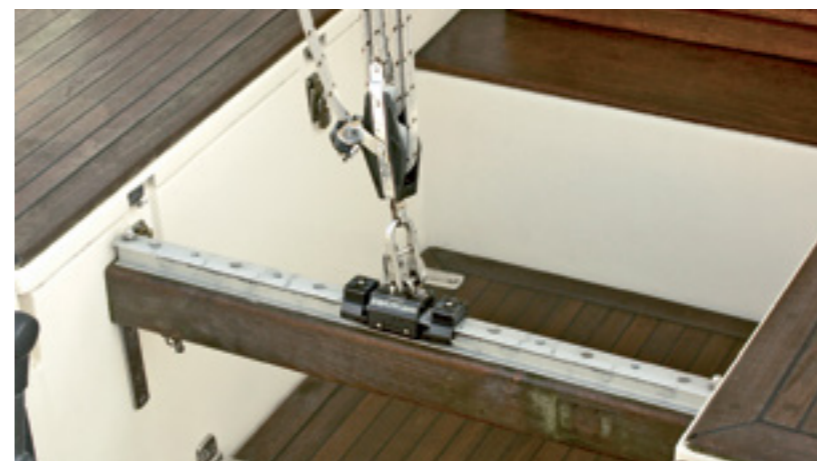
Der Traveller ist für wirkungsvollen Trimm zu kurz und sorgt schnell für angeschlagene Schienbeine. Fahrtensegler können durchaus darauf verzichten
